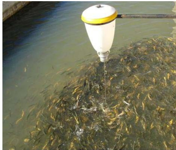
شکل ۲- دستگاه غذاده تقاضایی با مکانیسم جدید (N.D.F) نصب شده به روی استخر کانالی
