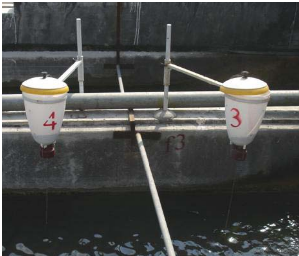
شکل ۲- دستگاه غذاده تقاضایی با مکانیسم جدید (N.D.F) نصب شده به روی استخر کانالی
